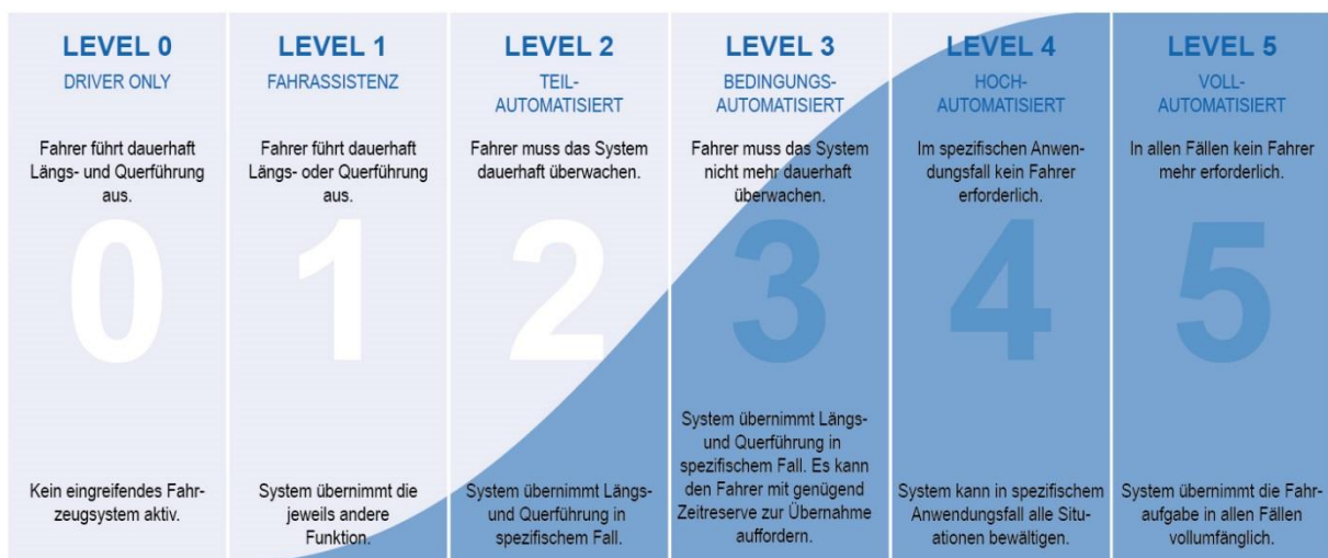
Abbildung 21: Levels des automatisierten Fahrens (nach [75]).
